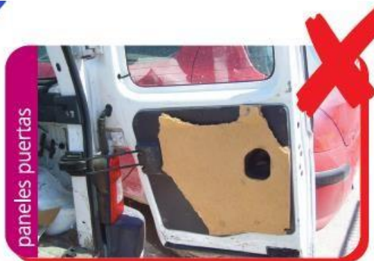
Daños en las puertas provocados por llevar la carga insegura
